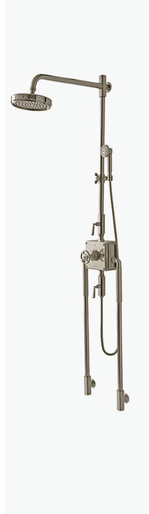
Système thermostatique apparent avec rosace de douche 8", bras, douchette, poignée ronde et poignées à levier MODÈLE : RWXS41 (US & EU) / RW41XS (UK)
